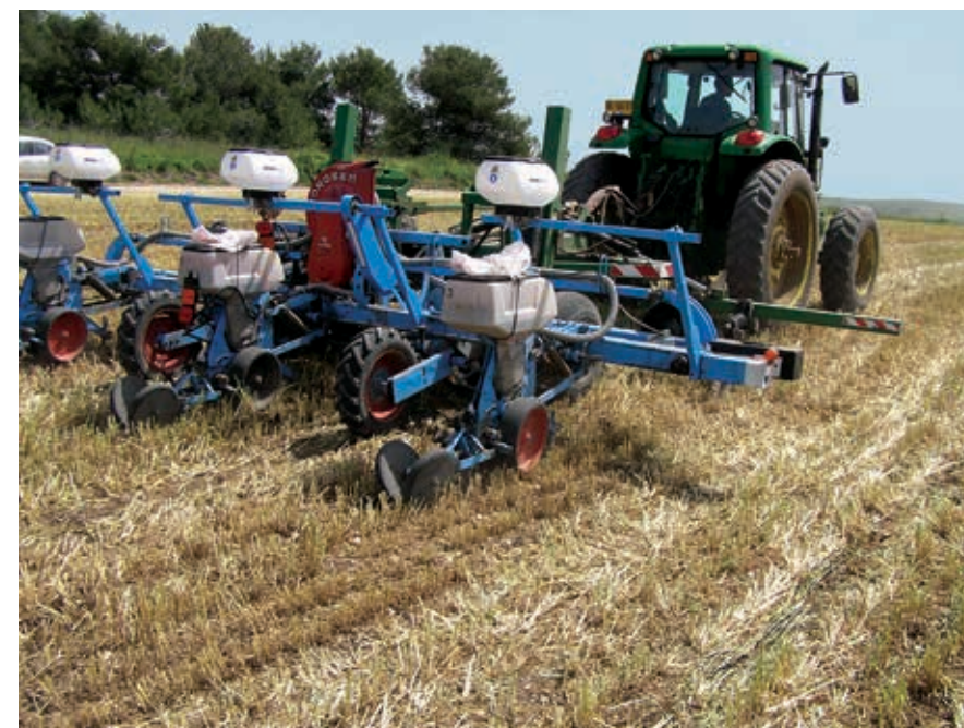
▲ מזרעת אי-פליחה, המזרעה מאפשרת החדרת הזרעים לקרקע באופן המפחית עיבודים הפוגעים במבנה הקרקע ובאופן המאפשר השארת כיסוי צמחי
